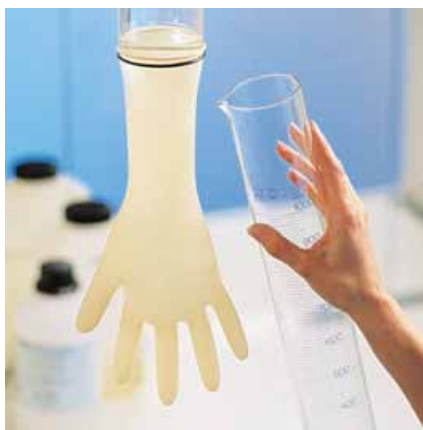
Contrôle de l'étanchéité à l'eau
