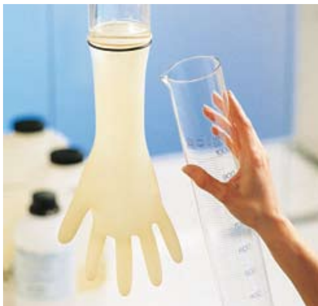
Wasserhalteprüfung nach EN 355-1
